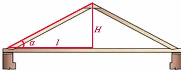
Для расчетов нам понадобится высота двускатной крыши. В нашем случае она обозначается буквой « $H$ ». Также необходимым параметром является проекция ската « $L$ ». Угол наклона можно обозначать не только в градусах, как это делают профессионалы, но и дробью, например  $1:3$ . Или же используют процентное соотношение:  $1:3 \times 100 = 33,33\%$ .
